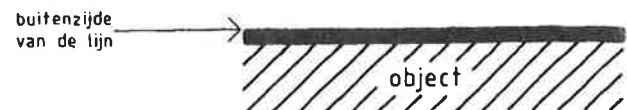
Figuur 8 – Vergroting van een begrenzingslijn, waarbij de meetkundige plaats op de buitenzijde van de lijn ligt
